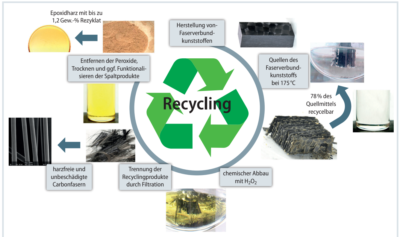
Bild 3. Durch die Cope-Chemolyse können harzfreie Carbonfasern aus carbonfaserverstärkten Epoxidharzen wiedergewonnen werden. Die Spaltprodukte des Harzes lassen sich ebenfalls erneut verwenden. Dabei besteht jedoch noch Forschungsbedarf. Quelle: TH Nürnberg; Grafik: © Hanser
